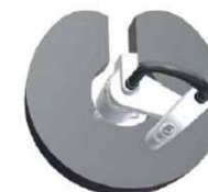
Роботы SCARA: овально изогнутая зона сервиса робота с мертвой зоной
