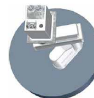
Цилиндрическая зона сервиса робота Epson Spider без мертвых зон
