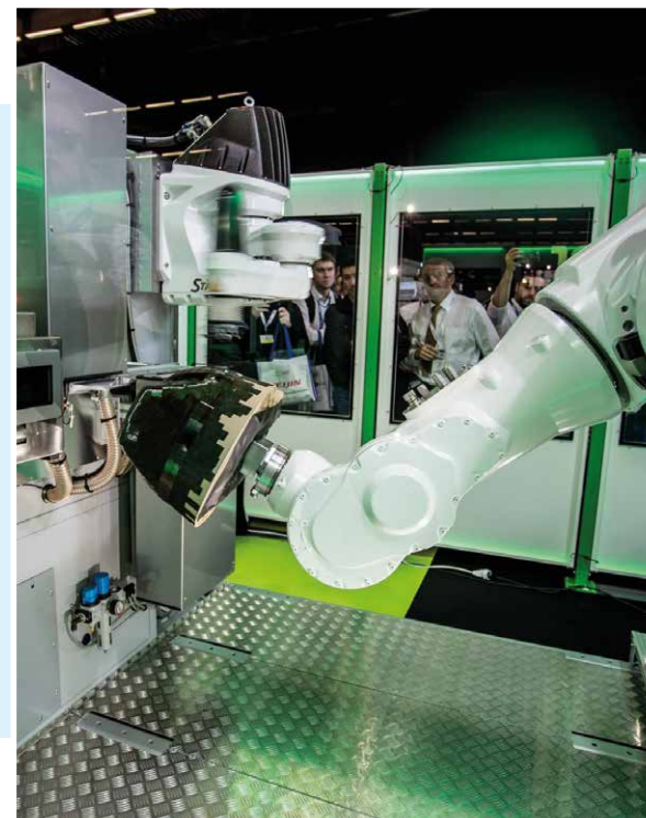
ВЫКЛАДКА КОМПОЗИТНОГО ВОЛОКНА С ПОМОЩЬЮ РОБОТА
