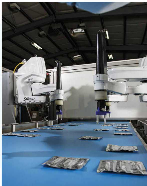
РОБОТИЗИРОВАННЫЙ КОМПЛЕКС ИСПОЛЬЗУЕТСЯ НА ПРЕДПРИЯТИИ ПИЩЕВОЙ ПРОМЫШЛЕННОСТИ ДЛЯ СОРТИРОВКИ И УПАКОВКИ ПРОДУКЦИИ
