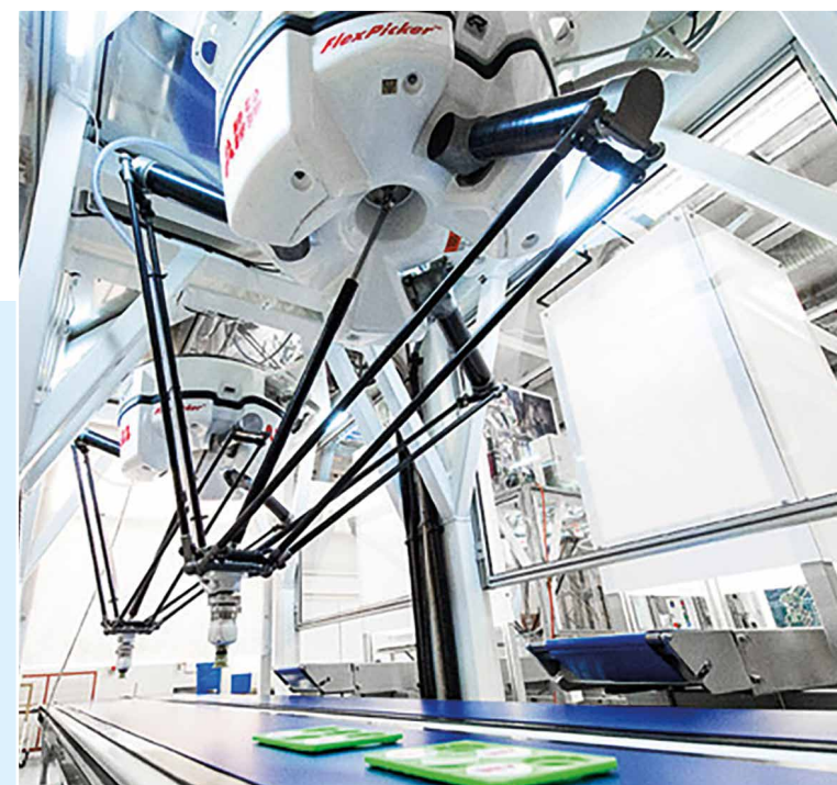
РОБОТ ABB FLEXPICKER. ПРИМЕНЕНИЕ В ПИЩЕВОЙ ПРОМЫШЛЕННОСТИ
