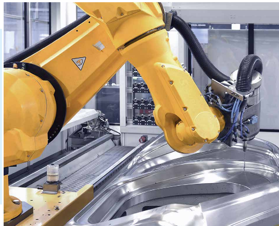
РОБОТ ИСПОЛЬЗУЕТСЯ ДЛЯ СВЕРЛЕНИЯ ГЛУБОКИХ ОТВЕРСТИЙ В ПРЕСС-ФОРМЕ
