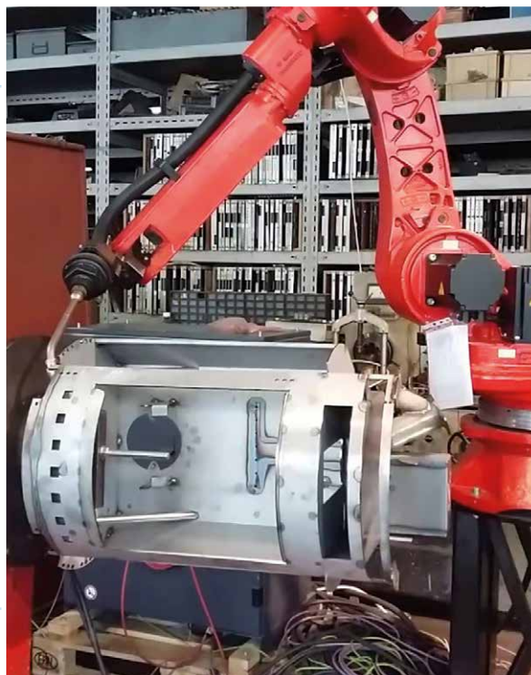
ЭЛЕКТРОДУГОВАЯ СВАРКА С ПОМОЩЬЮ РОБОТА
