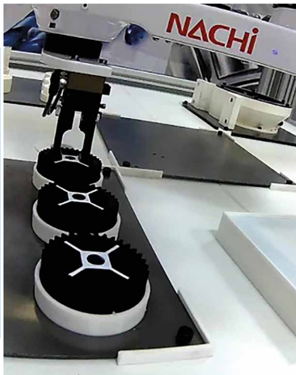
РАСКЛАДКА ДЕТАЛЕЙ С ПОМОЩЬЮ РОБОТА NACHI EZ03
