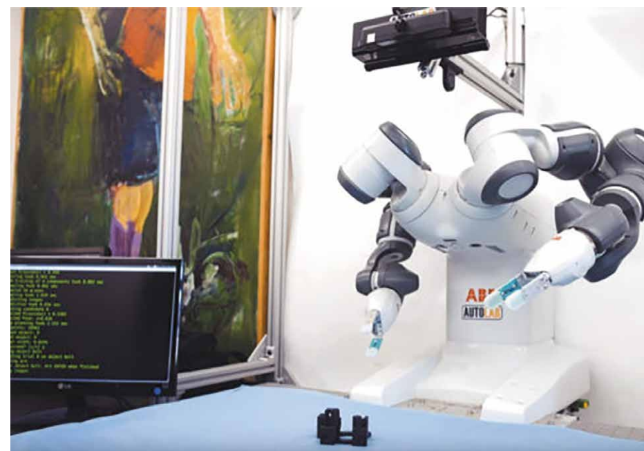
Робот манипулирует объектами, с которыми он никогда не сталкивался, прежде чем исследователи научат нейронную сеть распознавать объекты из миллионов трехмерных моделей и изображений
